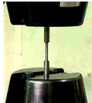
3 - Détail des mors et de l'éprouvette
