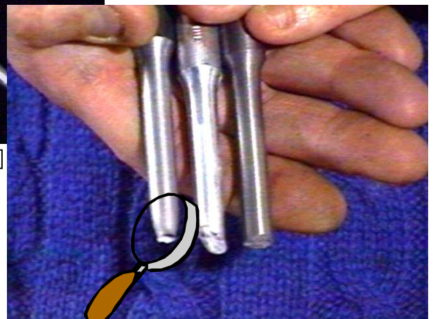
5 - Striction et formes de la cassure d'éprouvette
