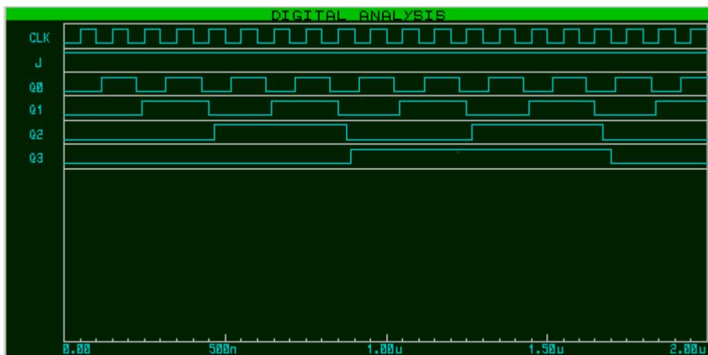
*La fréquence de l'horloge est de 10 MHz pour pouvoir observer le temps de propagation dû aux bascules asynchrones.*
