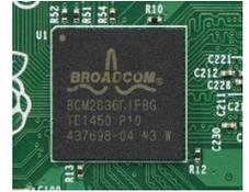
Le processeur BCM2836 utilise un jeu d'instructions machine de type RISC (Reduced Instruction Set Computer : jeu d'instructions machine réduit). Avec un jeu d'instructions machine réduit, chaque instruction est très simple afin d'être exécutée en 1 cycle d'horloge.
