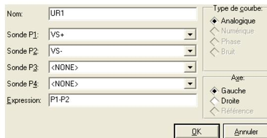
$UR1 = V_{s+} - V_{s-}$ . Cliquer sur
